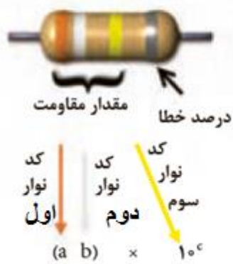
شکل ۱۶-۵ نحوه خواندن مقاومت رنگی
