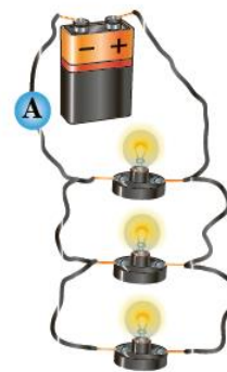
شکل ۲۲-۵ لامپ‌هایی که به طور موازی به هم بسته شده‌اند
